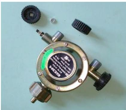
**unten rechts** das Originaldrehräddchen, das als Vorlage für die 3D-Konstruktion verwendet wurde, **oben** zwei 3D-Drucke mit massiveren Wandstärken und verlängerten Griffrollen.
