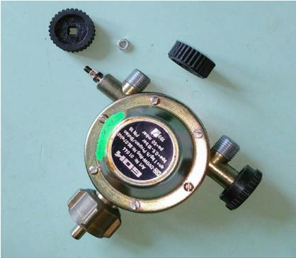
**unten rechts** das Originaldrehrädchen, das als Vorlage für die 3D-Konstruktion verwendet wurde, **oben** zwei 3D-Drucke mit massiveren Wandstärken und verlängerten Griffriellen.
