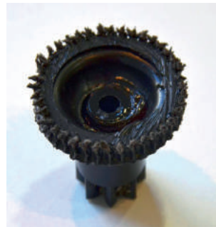
oben abgenutztes Motorzahnrad links 3D-reparierter Motorblock
